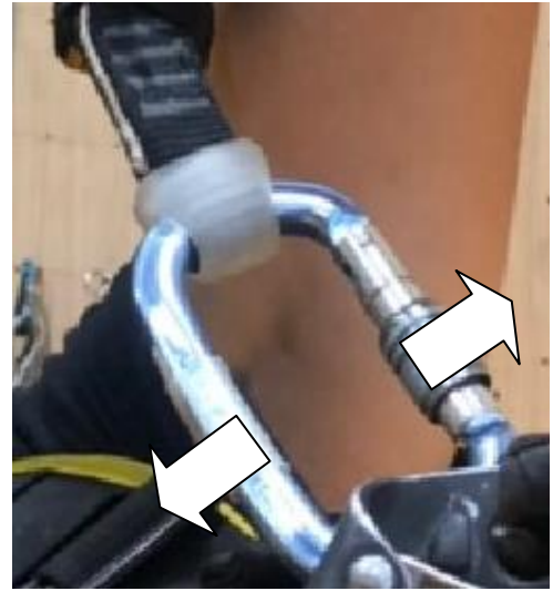
圖 10：開關開軸向靜止承載力測式
